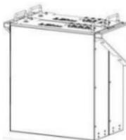
3.Fije la batería al orificio de fijación del soporte con tornillos M6 con 2,0 N·m aproximadamente.
