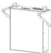
2.Taladre orificios en la pared para los tacos para tornillos de expansión M8, cuya profundidad debe ser de al menos 50 mm. Apriete los tornillos a un par de alrededor de 2,5 N·m.
