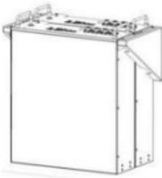
3. Befestigen Sie die Batterie am Befestigungsloch der Halterung mit M6-Schrauben und einem Anzugsmoment von 2,0 N-m.
